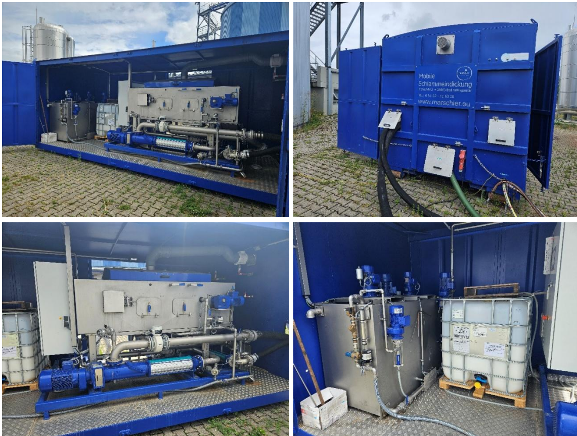
Abb. 18: Mobilanlage Bandeindicker Fa. Marschler
